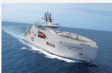
ケーブル敷設船
